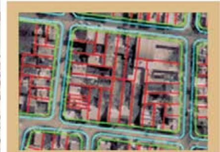
3.11 Superposición de una fotografía aérea escaneada (modo raster) con la cartografía de base (modo vectorial). En este caso se utiliza para reconstituir mediante procesos de digitalización el parcelamiento urbano.
