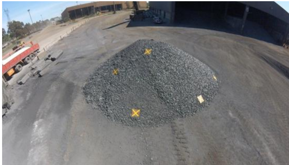
Figura 1: acopio de briquetas con placas de puntería distribuidas.
