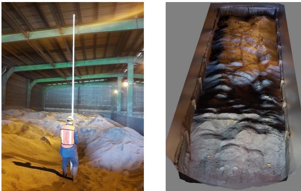
Figura 7: izquierda, fotografía durante el relevamiento; derecha, modelo tridimensional del acopio.
