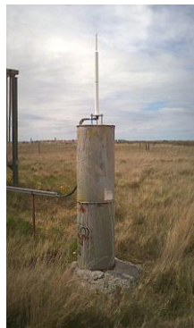
Figura 8: Antena DORIS de la Estacion EARG
