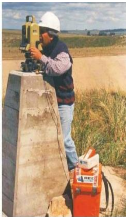
Figura 6 – Pilar de Auscultación Dique Cabra Corral – Salta - Argentina
