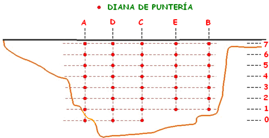
Figura 7 y 8 – Esquema de Auscultación de un Dique
