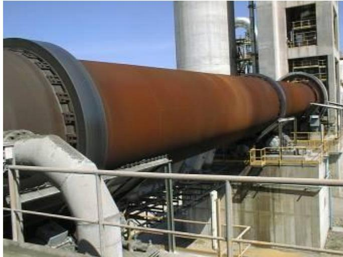
El tubo cilíndrico metálico exterior del horno rotatorio está constituido por un conjunto de elementos soldados llamadas virolas, fabricadas a partir de chapas de acero de un ancho de aproximadamente 2,20 m, con las cuales se forman tubos del diámetro interior del horno.
