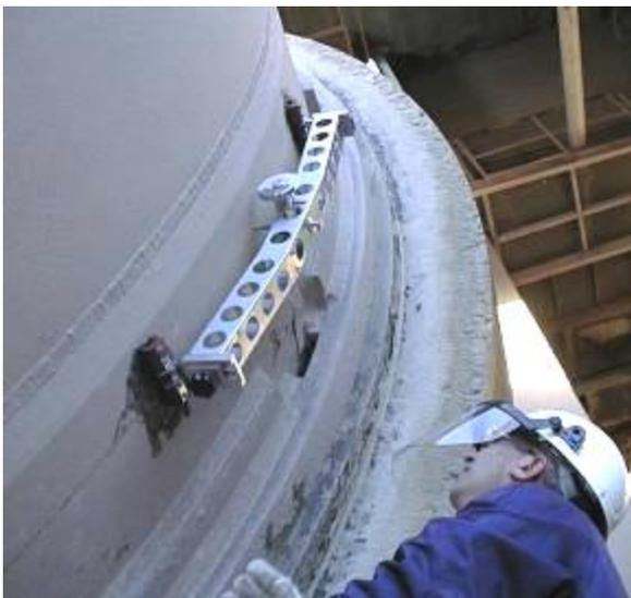
Las deformaciones radiales de la carcasa del horno se las registran mediante el **aparato de medición de deformaciones de hornos "Shelltest"**, como se muestra en la figura.
