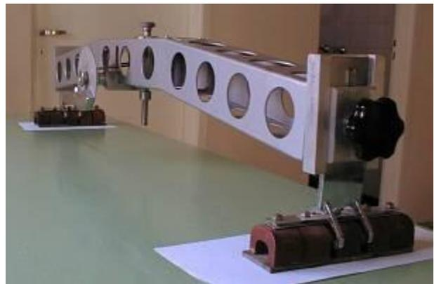
El aparato "Shelltest" consta de una estructura rectangular con dos porta imanes, el impresor, un disco pendular donde se dibuja del diagrama y una punta palpadora. Los movimientos de la punta palpadora, se transmiten a través de una cremallera y una rueda dentada al portamina inscriptor, el cual dibuja las desviaciones sobre el diagrama a escala 1:15.
