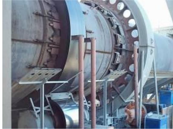
*Accionamiento del horno rotativo. Piñón y corona*
