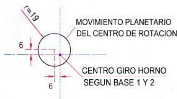
*Centro de rotación y su movimiento planetario (efecto cigüeñal), en función del centro físico actual*
