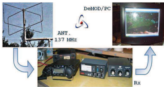
Fig. 1 Estación Terrena Receptora ETR-APT1 del InSTEC.
