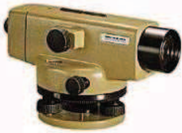
Nivel marca Leica modelo NAK2 Precisión: 0.7mm por Km 2niv. 0.3mm (with parallel-plate micrometer) Compensator setting accuracy: 0.3" Magnification standard 32x La placa plano paralela permite lecturas de 0.1mm y estimar: 0.01mm
